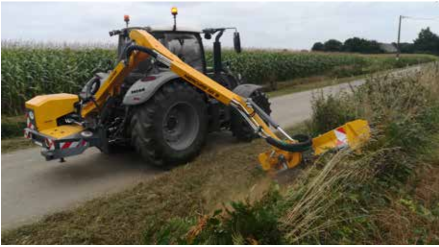
Modèle Mercure III Épareuse à bras coudé (800 mm), soit un avancement de 1,73 m entre les axes d'attelage et l'avant du groupe de broyage.
